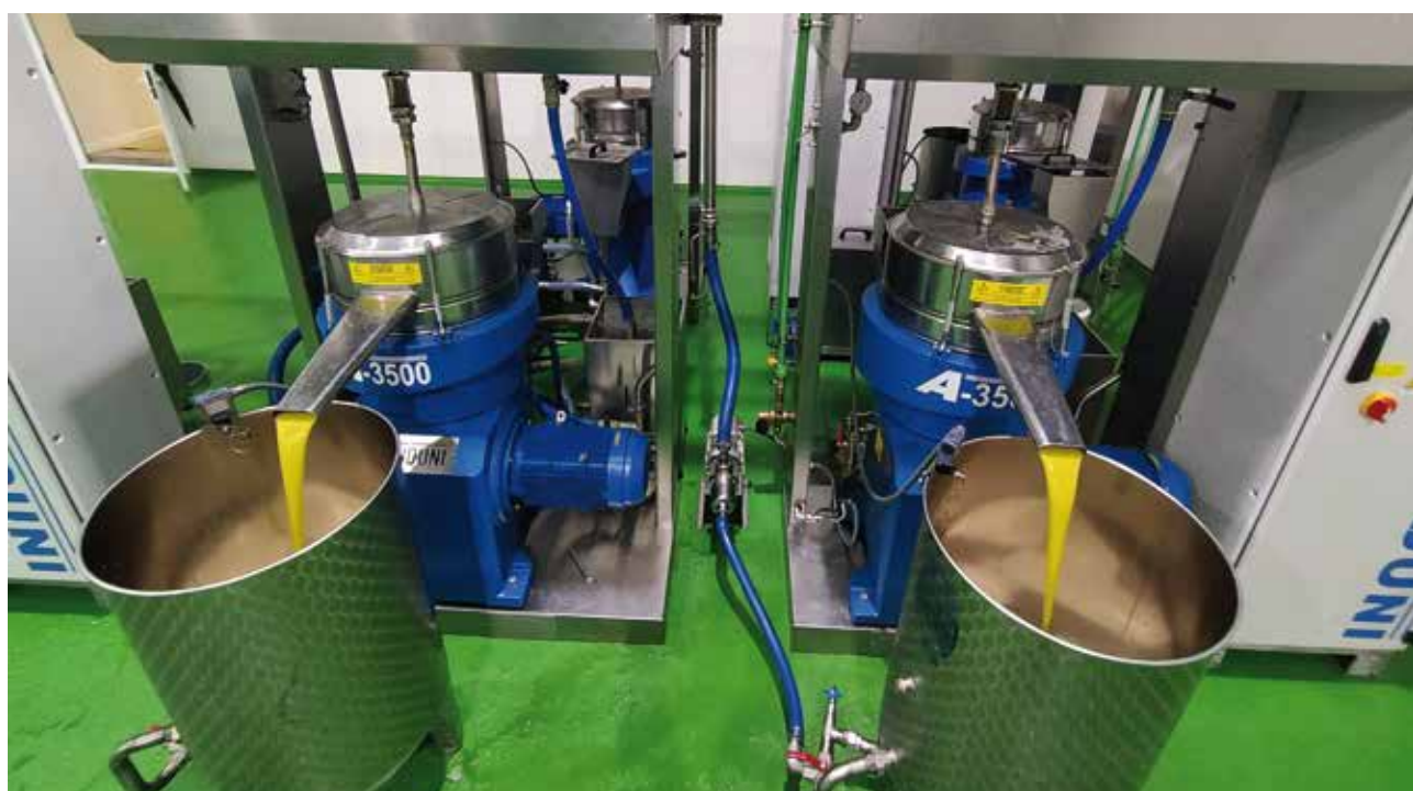
Figura 23. La accesibilidad y el control visual de ambas salidas de líquidos deben ser claves para decidir dónde colocarlas en la almazara.
