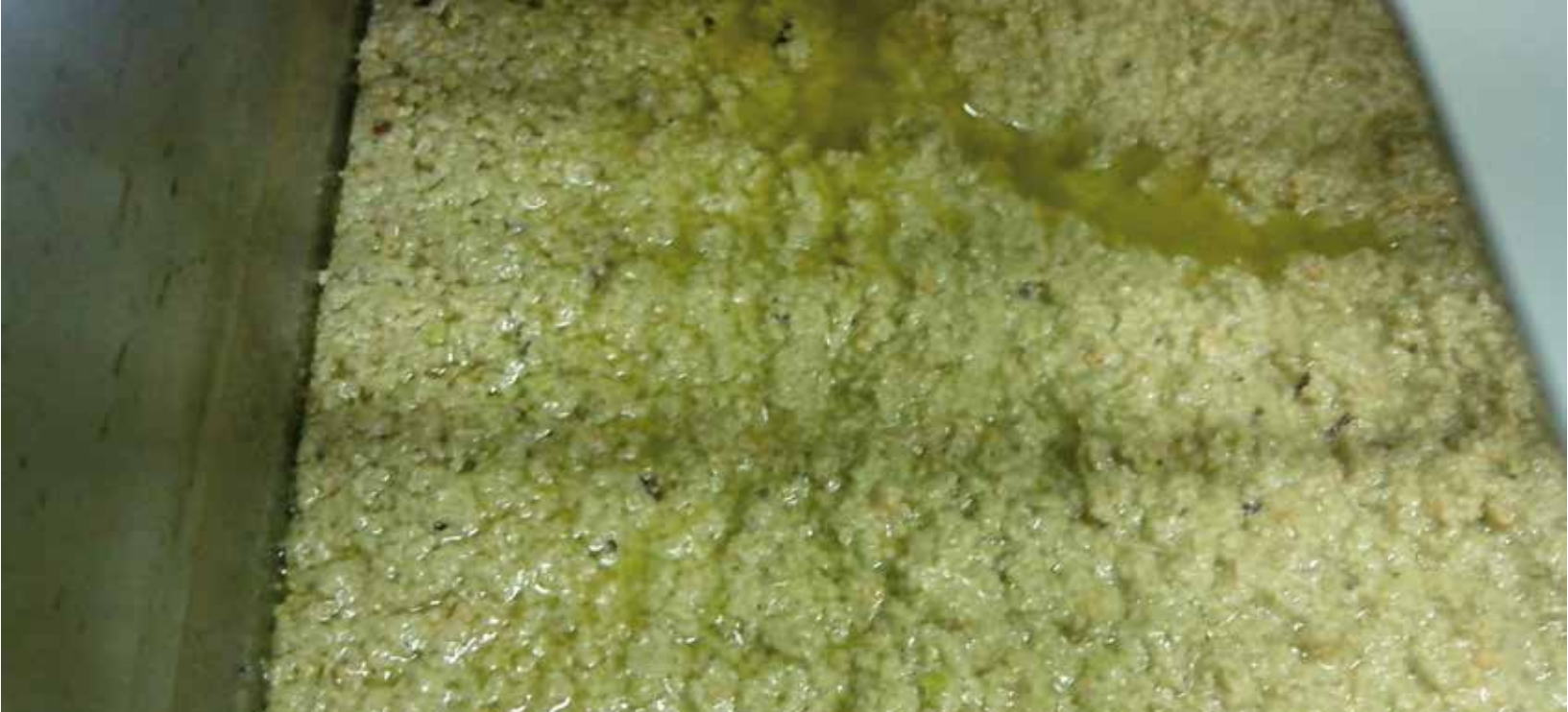
Figura 16. La coalescencia de las gotas de aceites provoca en ocasiones una gran "balsa" de aceite sobrenadante.
