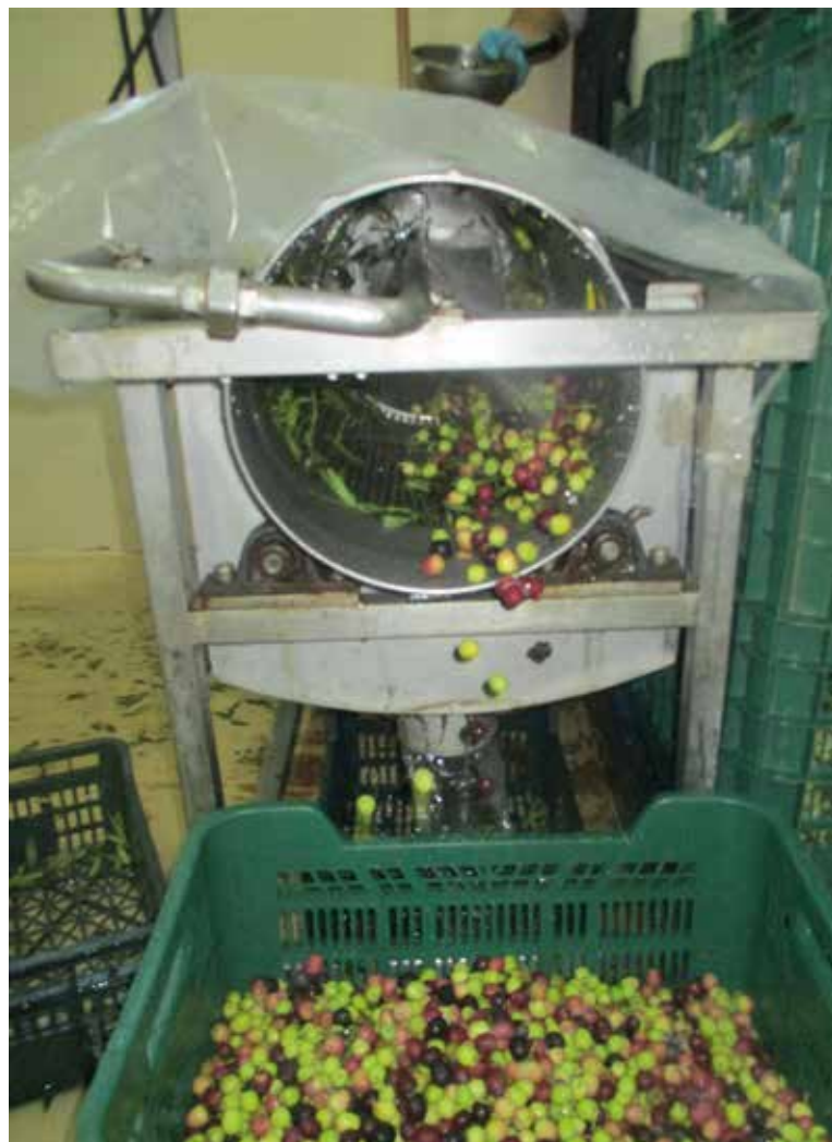
Figura 10. El lavado de aceituna es una opción que el maestro deberá decidir en función a factores intrínsecos de cada almazara.
