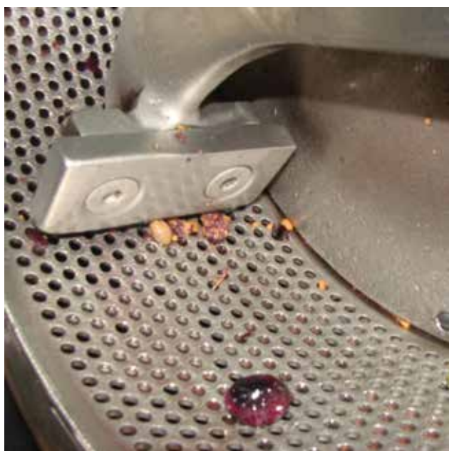
Figura 13. Un mal agotamiento de los orujos puede venir por un mal estado de conservación de pastillas y criba.
