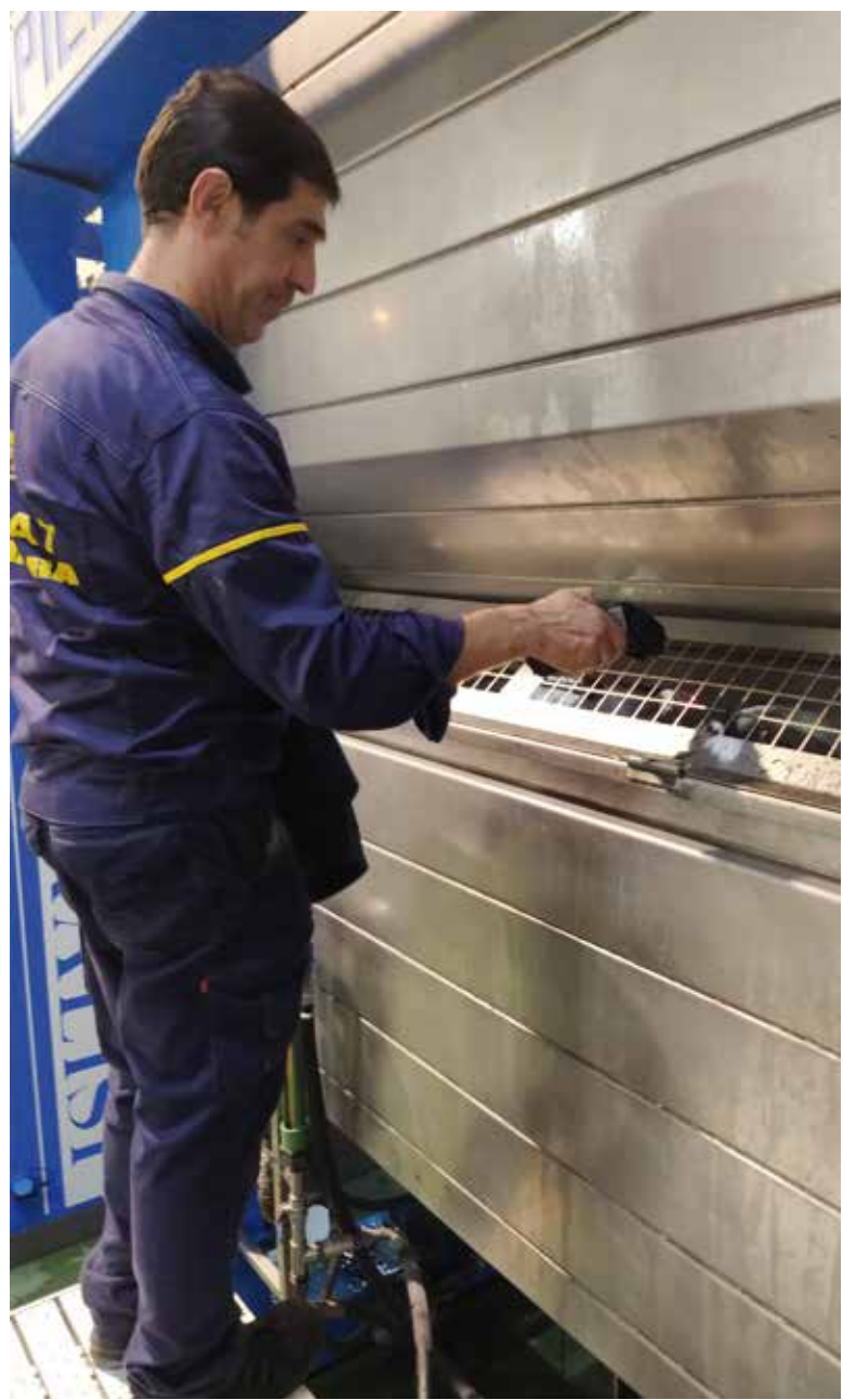
Figura 17. El control de la temperatura en batidora es clave para la calidad buscada, pero sobre todo tener la pasta a la temperatura consignada lo antes posible.
