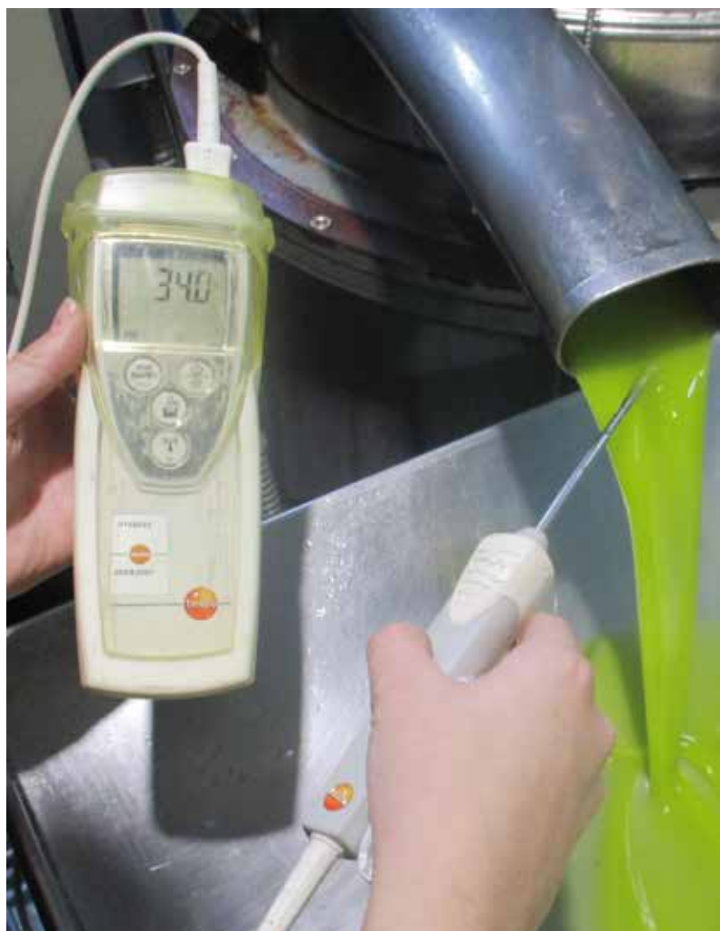
Figura 24. El control de la temperatura de salida del aceite es clave tanto para no perder calidad ni aceite en el alpechín.
