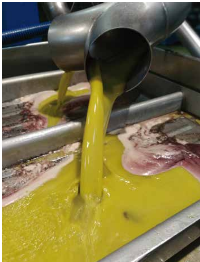
Figura 22. El tamiz puede provocar una pérdida importante de calidad si no es vaciado y limpiado a diario. Que posea una inclinación y un fácil desmontaje será vital para evitar aportar defectos al aceite.
