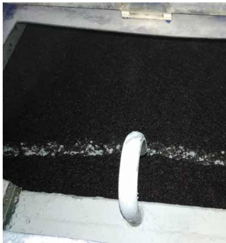
Figura 20. El punto y la forma de adición del talco deberá ser aquél que garantice su mezcla en la pasta y que no quede mezclado con el mosto oleoso descolgado.
