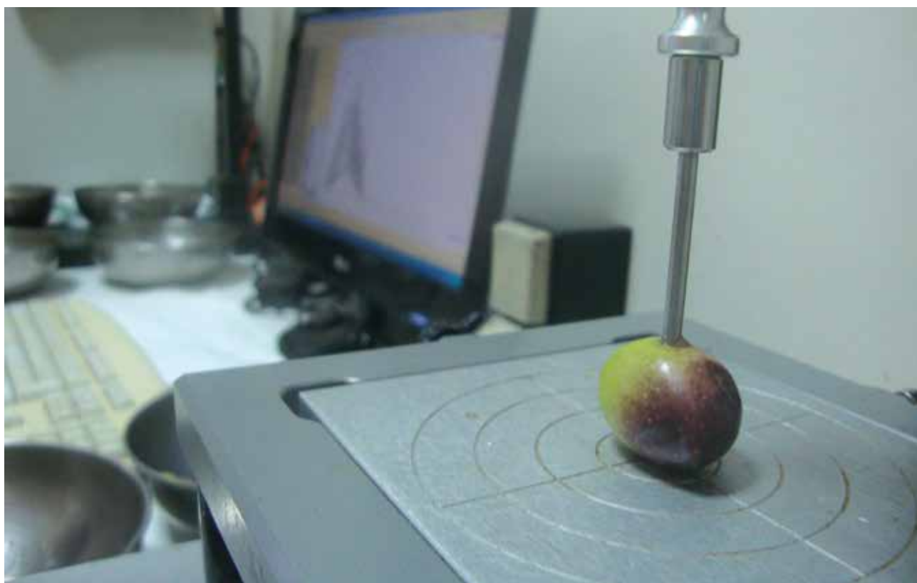
Figura 8. Detalle de la medida de los parámetros de dureza con el Texturómetro TA.XTplus con célula de carga de 5kg y punzón de 3 mm.
