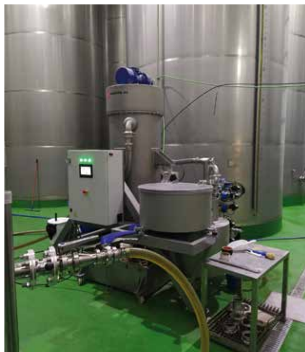
Figura 25. Filtrar el AOVE recién elaborado supone no solo un coste de proceso importante sino una pérdida de atributos positivos, pero que mejorarán las propiedades sensoriales y de color mejor en el tiempo.
