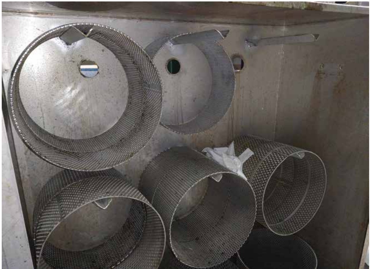
Figura 12. Las cribas deben conservarse ordenadas y protegidas contra deterioros.
